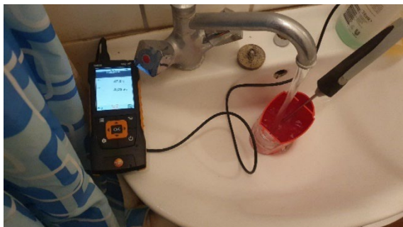
Foto 49. Måling af flow og temperatur for varmt brugsvand.
